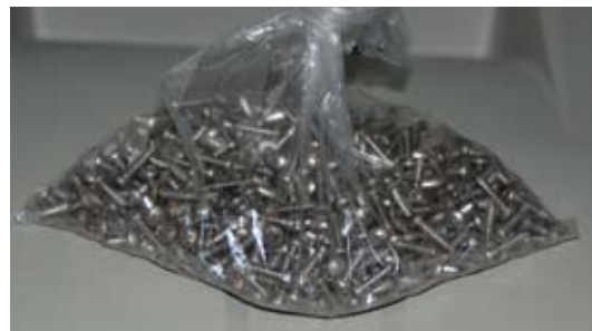
680 skruvar höll fast teakdäcket – 680 presumtiva hål för läckande vatten!
